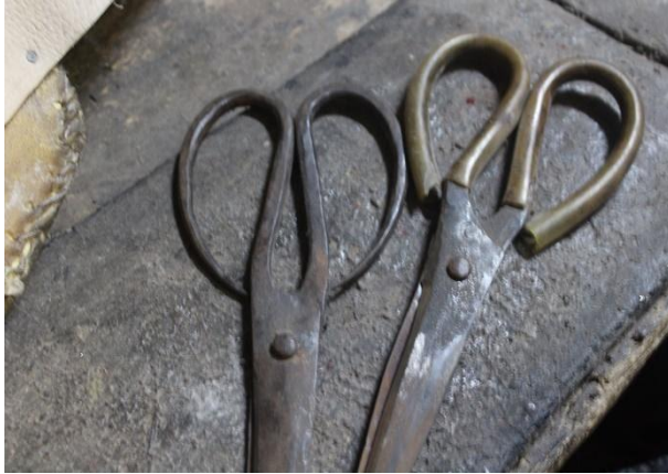
أمقاص يصنعها الحداد ويستخدمها السراج
