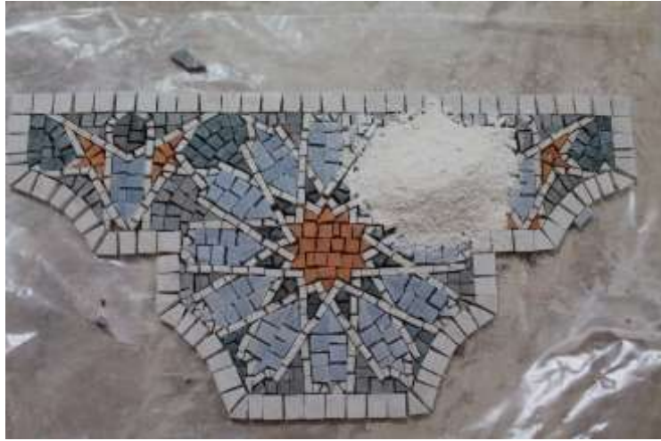
ملئ الفراغات بين المكعبات بخليط من الإسمنت الأبيض و الرمل
