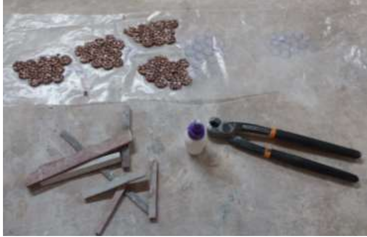
الأدوات المستعملة لقص و تثبيت المكعبات
