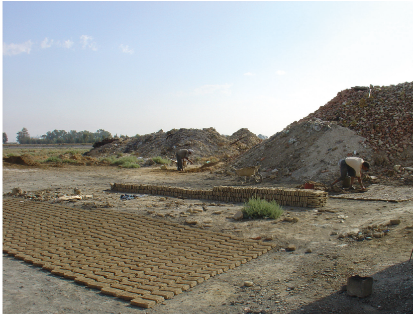
Fig. 39 : Troisième jour de travail du mouleur de briques de l'atelier de Mahdi Ben Bechir Adami de Kairouan en 2008 : les briques du premier jour sont disposées en haie, les briques du deuxième jour sont encore étalées et seront montées en haie après que le moulage du troisième jour soit terminé. À droite, le four à chaux et à briques avec son enrobage de déchets. Au centre, un ouvrier prépare les matériaux pour la réfection du foyer du four. En arrière-plan, le tas de rebuts. À gauche, les tas d'argile et de sable près du puits et de la fosse de malaxage. (cliché J.Thiriot).
